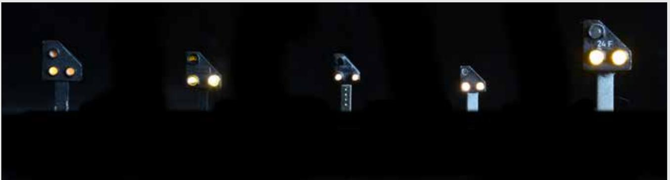
Die verschiedenen Lampen der Zwergleuchte leuchten nun alle ungefähr gleich stark. Beim Portigliatti Zwergsignal wurde der Wert der Dimmung am Ausgang 6 mit Absicht auf 45 belassen um den Unterschied in der Helligkeit zu zeigen.
