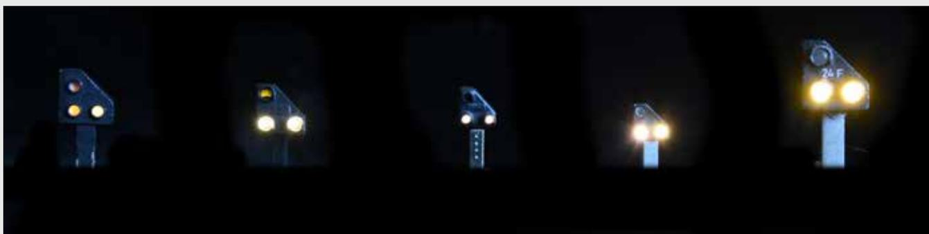
Das erste Einschalten zeigt, dass die LEDs unterschiedlich stark leuchten. Die beiden Zwergsignale von Barin (auf der rechten Seite) überstrahlen stark, beim Microscale Zwergsignal ganz links, leuchtet die Lampe unten links etwas schwächer als diejenige unten rechts. Das Portigliatti Zwergsignal (zweites von links) muss in der Leuchtkraft ebenfalls etwas zurückgenommen werden.
