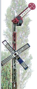
Das Bild zeigt eine Kombination aus einem einflügeligen Hauptsignal mit einem Rangiersignal, das heute als Räumungssignal bezeichnet werden würde.
