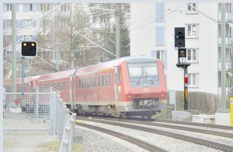
Bild: Situation in Neuhausen. Auf dem Gegengleis und links das Schweizer Signal und rechts das KS-Signal der DB. Das (natürlich blinkende) Grün ist gleichzeitig Vorsignal für das Schweizer Einfahrtsignal zum Bahnhof Schaffhausen. © Oliver Geißinger, Februar 2015.
