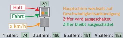
Ist bei der Konfiguration kein Fehler unterlaufen, werden Vor- und Hauptsignal immer gleichzeitig schalten und korrekte Signalbilder anzeigen, obwohl nur jeweils ein Schaltbefehl gegeben wird.
