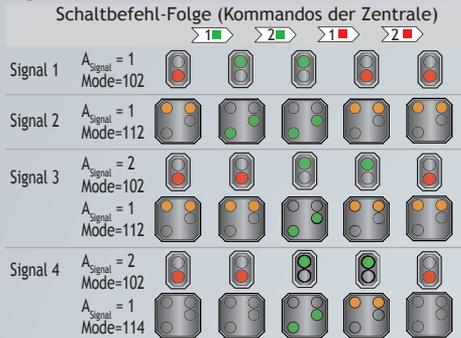
Im Bild sind Signalbildfolgen zusammengestellt, bei denen die Signale von Halt auf Fahrt und wieder auf Halt wechseln.
